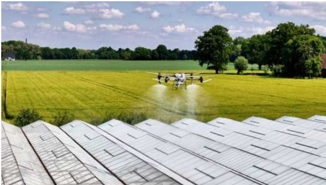
Die Agrardrohne im Einsatz: Hier schattiert die Drohne ein Gewächshaus am Niederrhein.
